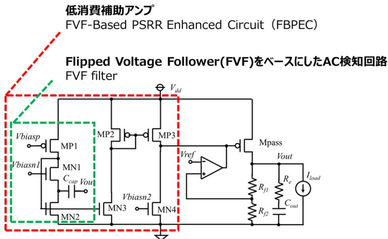
図 1 : 提案する回路構成(FBPEC)
