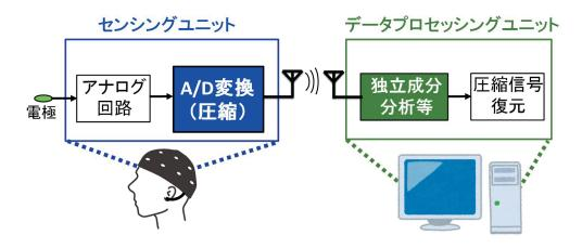
圧縮センシングを用いると、信号を圧縮しながらサンプリングを行い、回路で扱う情報量を削減出来るため、「回路の低消費電力化」が可能になる。これは搭載バッテリーサイズの小型化や長時間動作に繋がる。ただし、一般的な圧縮センシング手法では、外乱混入に脆弱であり復元精度が悪化する等の課題に悩まされてきた。そこで兼本らは、独立成分分析やK-SVD法などを活用した新技術を開発し、復元精度の改善や更なる高圧縮化の実現を目指し研究を行っている。右図は提案シーズ技術を活用した成果例であり、外乱が混入しても、信号を高精度に復元出来ることを示している。
